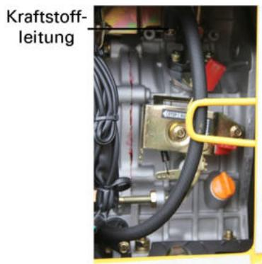
Kraftstoff aus dem Tank ablassen. Die schwarze Leitung ab dem Kraftstofffilter am anderen Ende von den Schellen lösen und den Tank entleeren.
