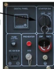
Lassen Sie diese bei laufendem Motor immer auf Position **ON** stehen.
