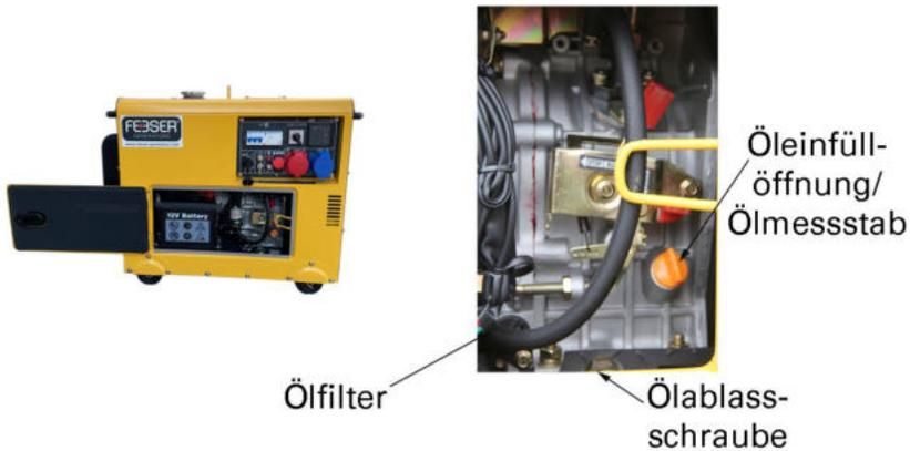
Entfernen Sie die Öleinfüllschraube und wischen Sie den Peilstab ab. Kontrollieren Sie den Ölstand, indem Sie den Ölpeilstab in den Füllstützen schieben ohne ihn festzuschrauben. Ziehen Sie den Stab nach einigen Sekunden wieder heraus. Ist der Ölstand unter der Peilmarkierung, füllen Sie mit dem empfohlenen Öl bis zum oberen Rand des Öleinfüllstutzens auf. Die maximale Ölfüllmenge beträgt 1,7l.
