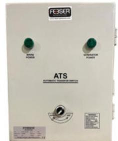
An die Klemmen „Hausanschluss“ werden 230 V (400Volt) von Ihrer Hausinstallation angeschlossen, die Generatorklemmen verbinden Sie bitte über einen Stecker 230 V (400Volt) mit der Steckdose des Stromerzeugers, an den Klemmen „Ausgang“ wird das zu versorgende Gerät angeschlossen. So wird die angelegte Spannungsversorgung überwacht und im Fall eines Stromausfalles startet der Generator nach einigen Sekunden **automatisch** und übernimmt die Netzversorgung. (weitere Informationen siehe S.17)
